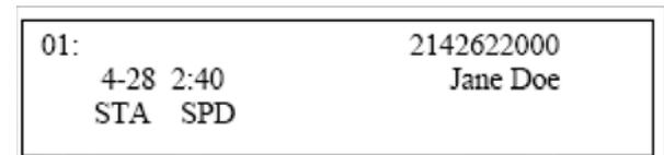
PASSO 3: Selecionar **STA** para armazenar um Arquivo Binário de Discagem Abreviada ou selecionar **SPD** para armazenar em um Arquivo Binário de Discagem Abreviada do Sistema. Selecionar **TELBK** para armazenar em uma Agenda Telefônica.
